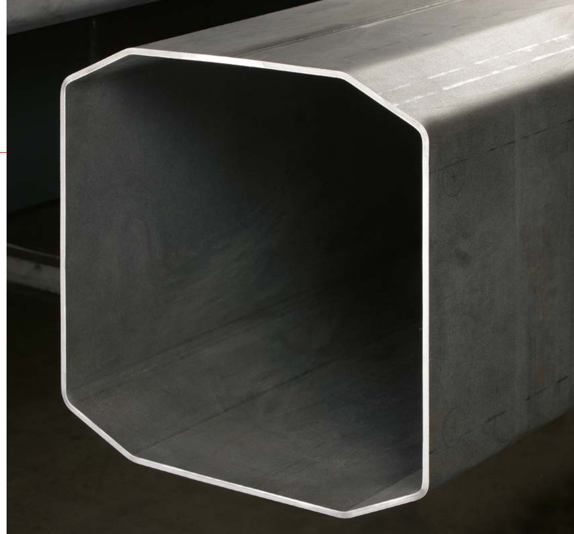
Lasergeschweißtes 8-Kantprofil aus S690QL, t = 8 mm, geschlossenes Kanten mit einer Laserschweißnaht
