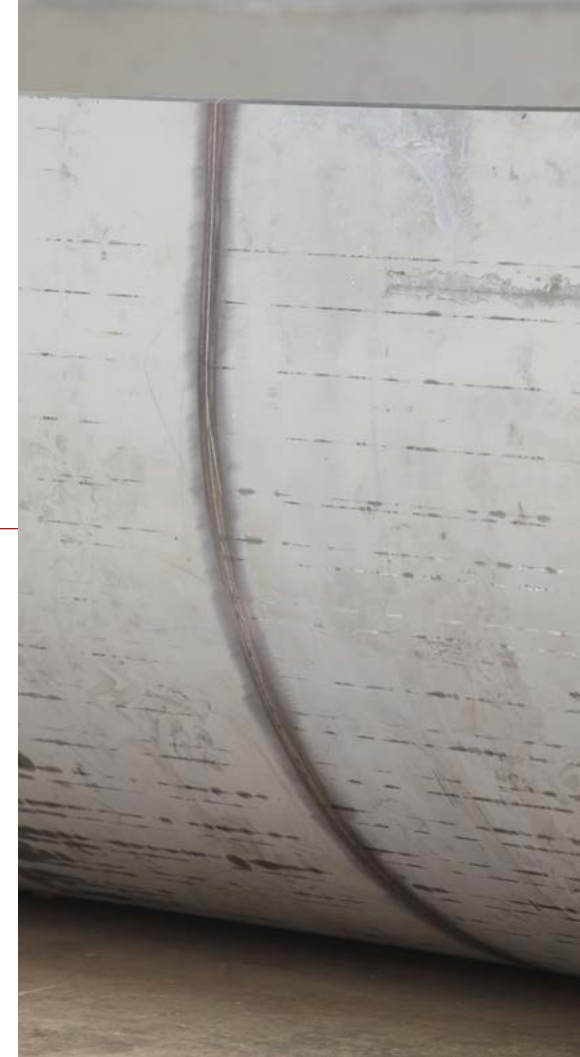
Material S1100QL mit einem Blechdickenunterschied von 7 mm auf 8,5 mm
